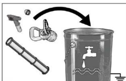
**5** Снимите комплект заборного шланга с сливным шлангом и поместите в промывочную жидкость. Используйте водяной кондиционер или помповый кондиционер для краски на водной основе и уайт-спирит для краски на масляной основе.
