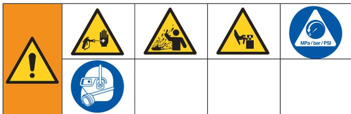
Это оборудование остается под давлением до тех пор, пока давление не будет сброшено вручную. Во избежание получения серьезной травмы, вызванной жидкостью под давлением (например, в результате прокола кожи, разбрызгивания жидкости и контакта с движущимися деталями), выполняйте процедуру сброса давления после каждого завершения распыления и перед очисткой, проверкой либо обслуживанием оборудования.
