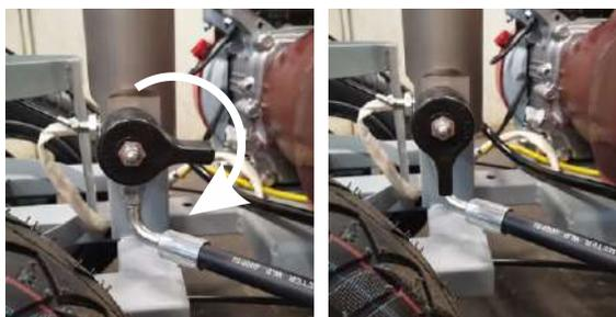
**4** Поверните регулятор давления против часовой стрелки на самое низкое давление.
