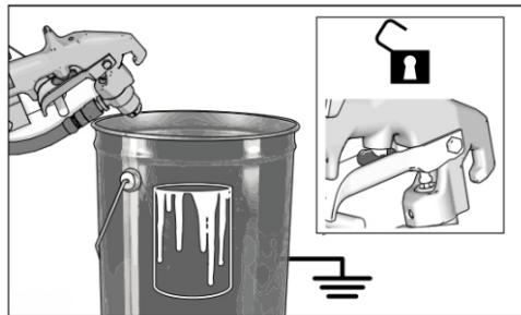
**9** Постепенно поворачивайте ручку регулятора давления до тех пор, пока двигатель не начнет приводить насос в движение. Нажимайте на пусковой курок пистолета до тех пор, пока не появится жидкость для промывки.
