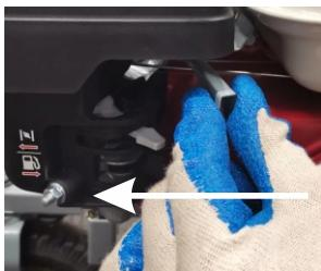
d. Установите переключатель запуска двигателя в положение on.
