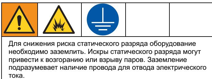
Для снижения риска статического разряда оборудование необходимо заземлить. Искры статического разряда могут привести к возгоранию или взрыву паров. Заземление подразумевает наличие провода для отвода электрического тока.
