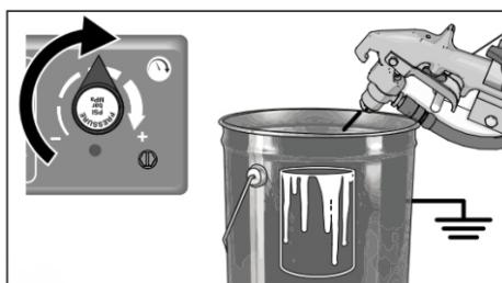
**10** Переместите пистолет в ведро для промывки, прижмите пистолет к ведру, для тщательной промывки системы. Отпустите и заблокируйте спусковой крючок. Постепенно поворачивайте регулятор давления до тех пор, пока двигатель не начнет приводить в движение насос. Пока из краскопульта не появится промывочная жидкость.
