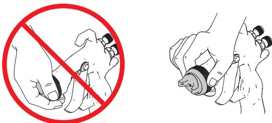
4. Вставьте сопло (7) в воздушную головку (8а) таким образом, чтобы фиксирующий язычок сопла был расположен в прорези воздушной головки. См. Рис. 7.
